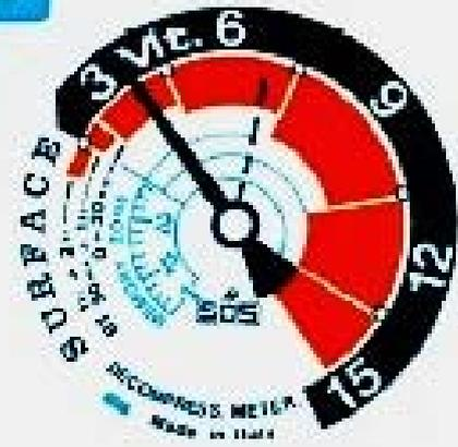
Die Nadel ist in die 3 mtr-Zone eingetreten. Der Taucher kann bis zu 3 mtr aufsteigen.
