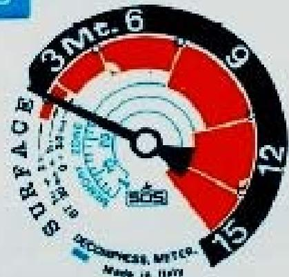
Der Zeiger hat den vorgesehenen Punkt für das Ende der Dekompression erreicht-(Grenze rote Zone entsprechend der Tauchdauer von 30 Minuten bis zu 1 Stunde, bitte Angaben seite 7 lesen). Der Taucher kann das Wasser verlassen. Die Nadel geht von diesem Moment an langsam auf 0 zu in der Gedächtnis-Zone.
