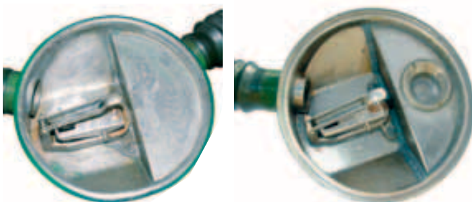
Linker Regler: PA60/1 mit abgenommener Membran. Linke Seite: Blick auf das Hebelwerk. Der einstufige Druckminderer ist vom Delphin übernommen worden. Rechte Seite: Die nach innen geschlossene Kammer für das Ausatemventil. So war es möglich, neben dem Einatemstutzen (links) auch den Ausatemstutzen (rechts) an der Bodenschale zu befestigen.
