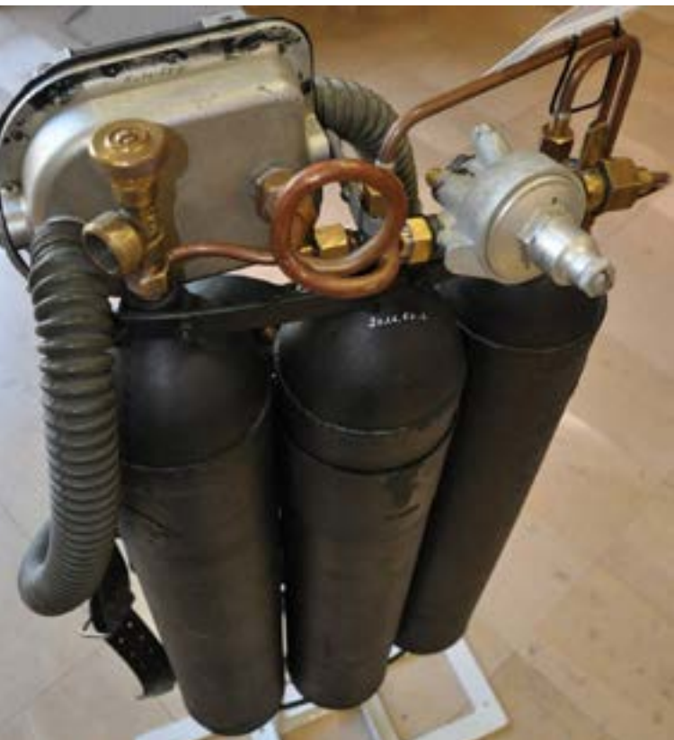
Hochdruck- und große Reglerstufe der CG45-Vorversion am Flaschen-Triple
