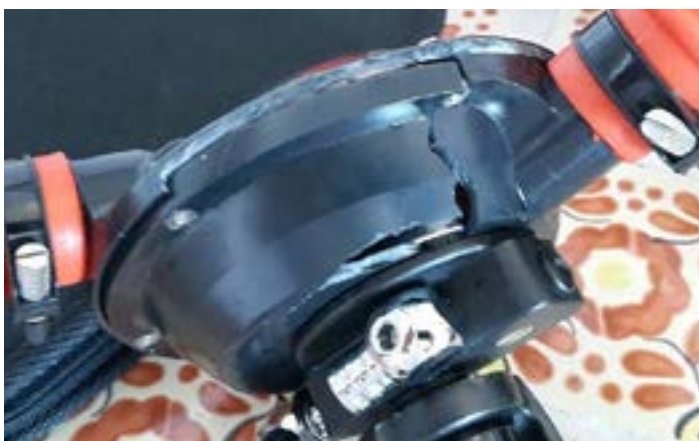
Zerstörtes Gehäuse infolge umgefallenem PTG
