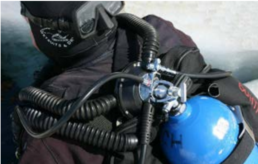
Mögliche Schlauchführung mit dem Kracken
