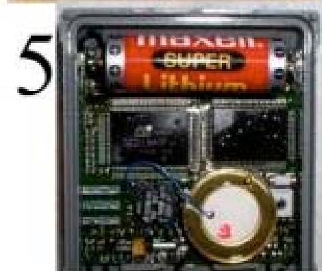
Maxell Super Lithium SL 750T einlöten
